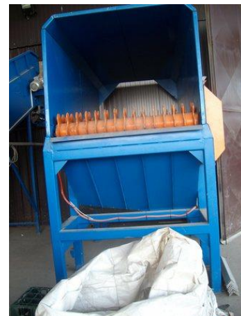
Слика 4.5.1-5. Коси тракасти транспортер и сепаратор за издвајање компоненти из отпада
