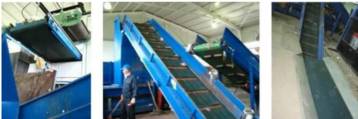
Слика 4.5.4-10. Излаз сортираног отпада из сортирнице и коси транспортер који транспортује отпад из сортирнице и из боксева са сортираним отпадом до пресе – балирке
