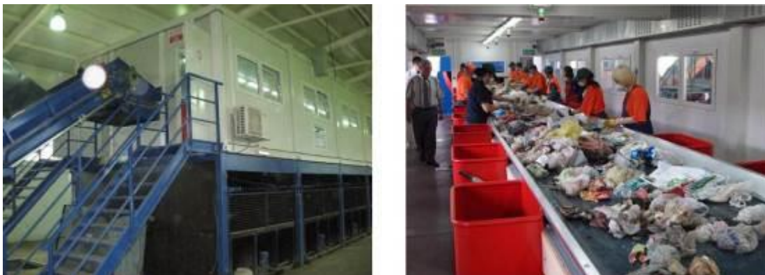
Слика 4.5.4-7. Сортирница мешаног комуналног отпада који је одвојен од биоразградивог отпада
