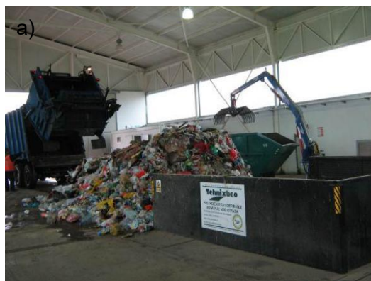
Слика 4.5.4-4. а) Истоваривање мешаног комуналног отпада у прихватну комору; б) прихватна комора са транспортером бр. 1
