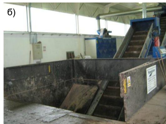
Слика 4.5.4-4. а) Истоваривање мешаног комуналног отпада у прихватну комору; б) прихватна комора са транспортером бр. 1
