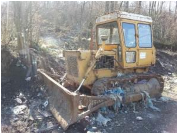
Слика 4.4.6-1. Булдозери за разастирање и равнање отпада на депонији ЈКП „Осечина“, "14 октобар", ТГ 120
