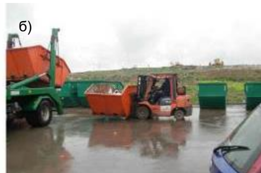
Слика 4.5.4-3. а) Истоварање контејнера са комуналним отпадом; б) виљушкар преузима контејнер са отпадом
