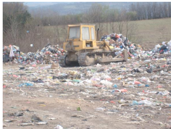
Слика 4.6.2-3. Булдозер за рад на депонији
