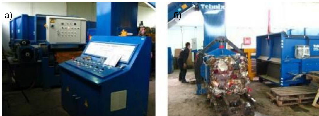
Слика 4.5.4-12. а) Командне табле за сортирницу и балирку; б) аутоматска преса - балирка
