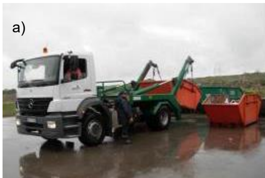
Слика 4.5.4-3. а) Истоварање контејнера са комуналним отпадом; б) виљушкар преузима контејнер са отпадом
