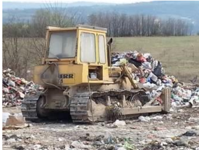
Слика 4.4.10-3. Булдозер за разастирање и равнање комуналног отпада на депонији отпада у Барошевцу
