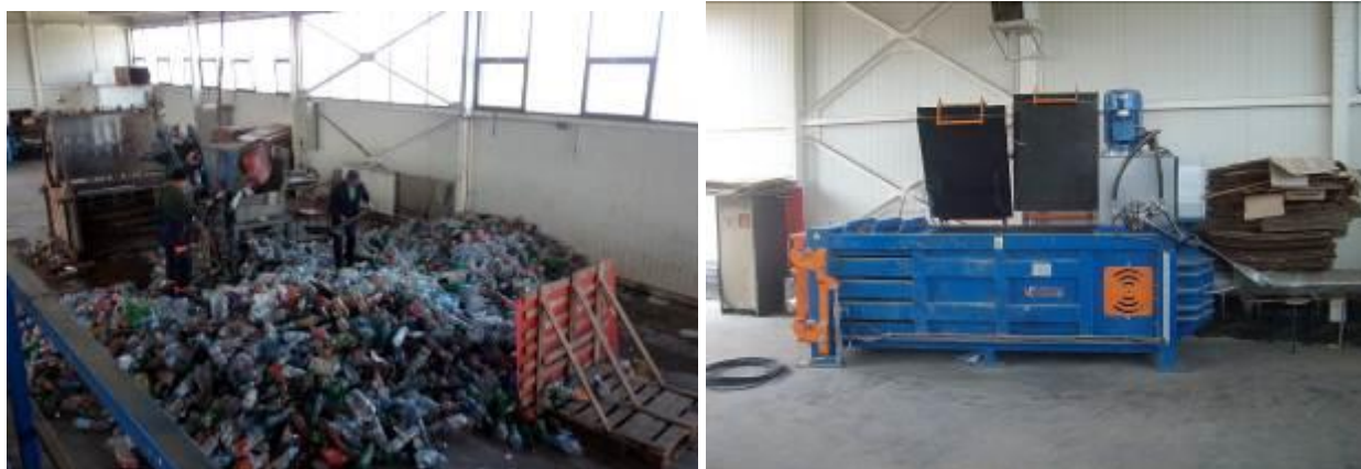
Слика 4.5.1-7. Преса за балирање и балирка.
