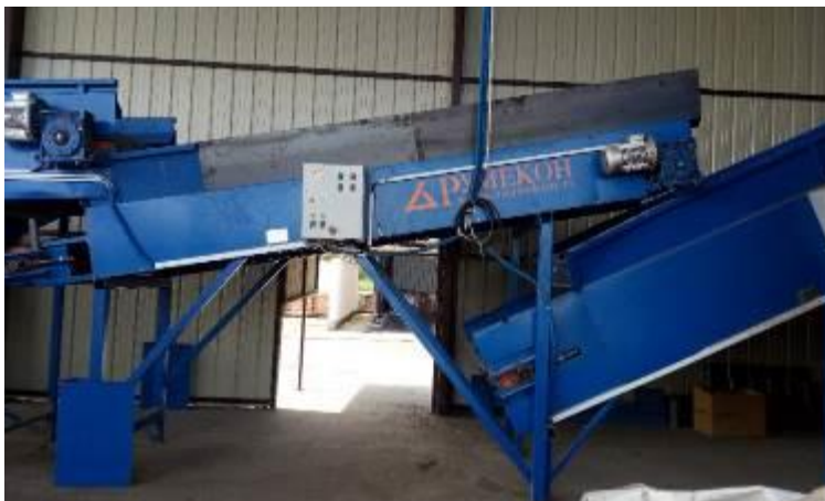
Слика 4.5.1-5. Коси тракасти транспортер и сепаратор за издвајање компоненти из отпада
