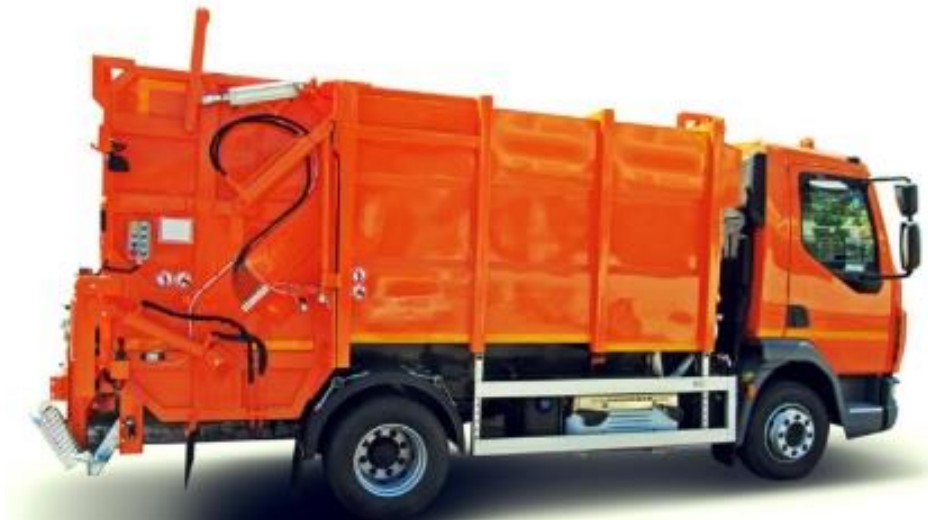
Слика 10-4. Типски камион смећар са потисном плочом
