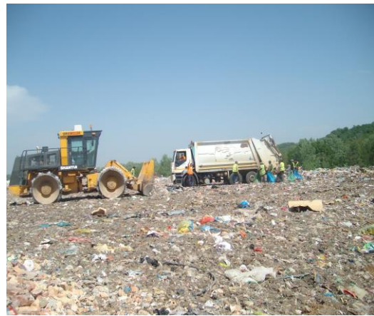
Слика 4.6.3-2. Компактор за рад на депонији и смећар
