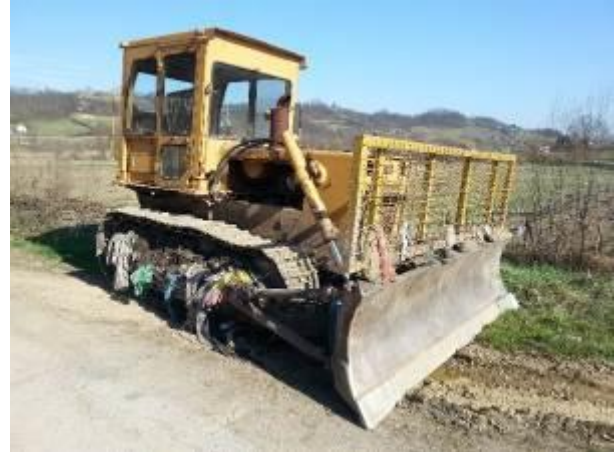
Слика 4.4.6-1. Булдозери за разастирање и равнање отпада на депонији ЈКП „Осечина“, "14 октобар", ТГ 120
